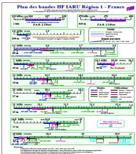
C'est un plan des recommandations d'utilisation des bandes HF pour la France métropolitaine et la Réunion, réalisé sous forme graphique.
