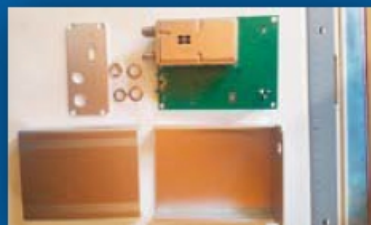
Ensemble récepteur DATV Minitouner-S et son tuner NIM FTS-4334LH.
