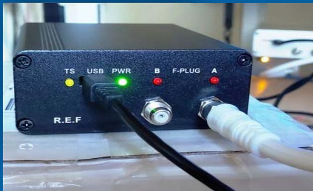
*Livré avec boîtier. Récepteur TV satellite numérique, DATV à bande étroite, mono canal*
